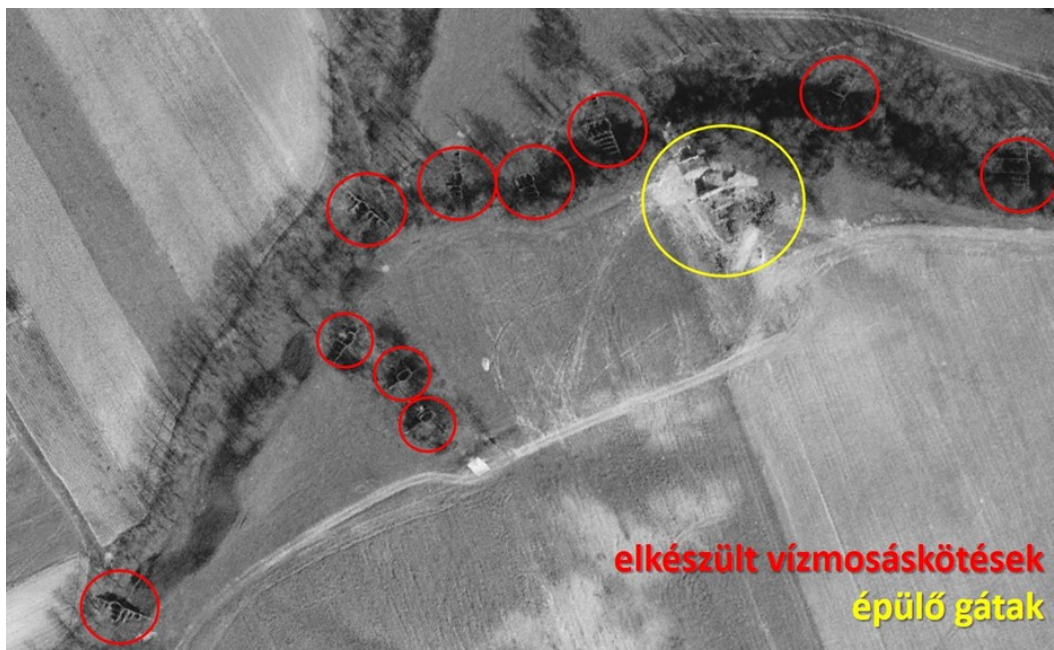
Fotó: Padragkúti vízmosás légifotója hordalékfogó gátakkal (1972. év)
